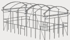
Réalisée sur la base d'une structure métallique déportée qui viendra encadrer votre court, cet ouvrage auto-porté sera totalement indépendant de l'existant et sera seul à supporter la descente de charges de la couverture.
